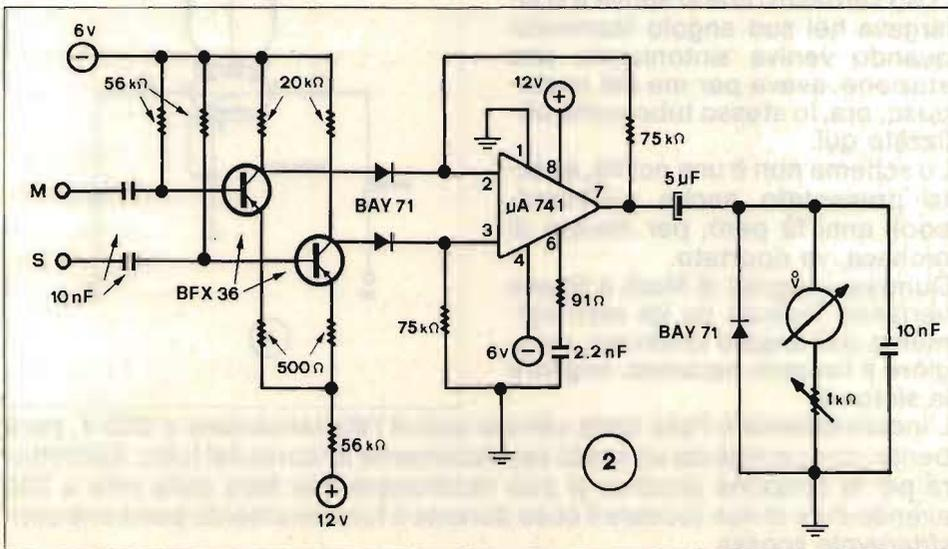
L'integrato è montato come sommatore dei due segnali all'ingresso dando un'uscita in cui entrambi i segnali sono sommati, nel senso che l'indicazione della perfetta sintonia si avrà allorché lo strumento indicherà il massimo segnale.
