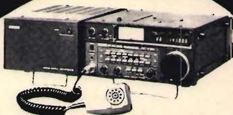
Ricetrasmittitore HF / Stazione base / Ricevitore a copertura cont. 1,5 - 30 MHz / Trasmissione 10-15-20-40-80-160 m + Warc (a richiesta, cop. continua 1,5-30 MHz trasmissione)
