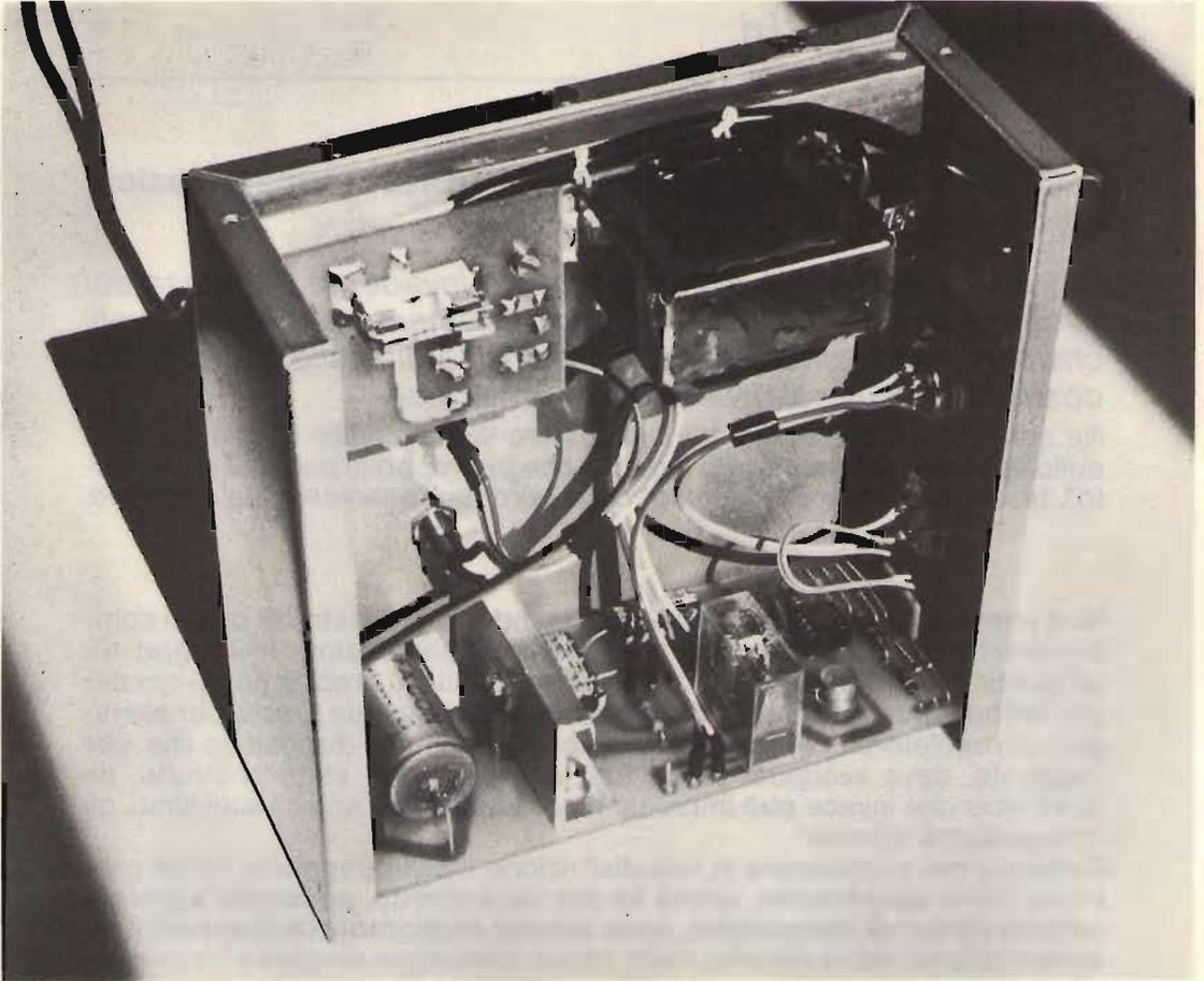
Qualora, una volta montato il circuito, si dovesse riscontrare un irregolare funzionamento, si dovrà ridurre il valore della resistenza  $R_1$ , la quale, come si è detto, dovrà avere il valore più alto possibile compatibilmente con un regolare funzionamento. \*\*\*\*\*
