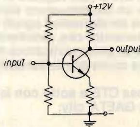
Si voleva conoscere l'esatto valore delle resistenze partendo da colori in codice dati alla rinfusa con la clausola che l'amplificatore doveva lavorare a larga banda e in maniera del tutto lineare.
