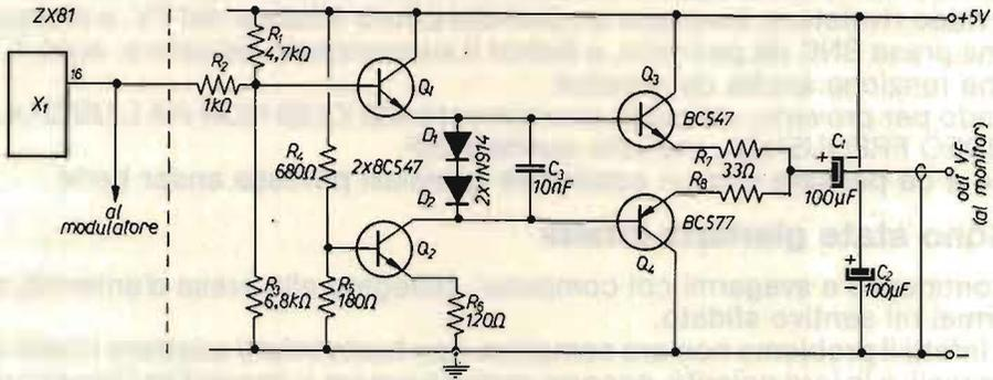
Il segnale ivi presente viene accoppiato direttamente alla base di  $Q_3$ . Inalterato in ampiezza, ma con componente continua ridotta di 1,5 V all'incirca, rispetto a quanto presente su tale elettrodo, lo ritroviamo anche a valle dei due diodi  $D_1$  e  $D_2$ , verso la base di  $Q_4$ .
