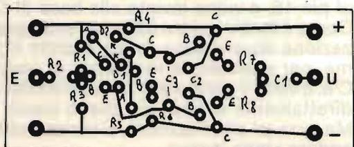
Realizzate il tutto come siete abituati ormai da tempo, con componenti piccolini, e con buone saldature. Ponete in piedi le resistenze, fate attenzione alle saldature.
