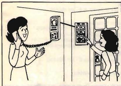
Il sistema VIDEO-DOORPHONE TD è la combinazione di un citofono con un impianto televisivo a circuito chiuso. L'unità interna, che include il monitor, viene installata in casa e l'unità esterna, costruita a prova di vandali, racchiude la telecamera, i faretto, il microfono e l'altoparlante, e viene installata in strada, vicino alla porta d'ingresso. Con questo sistema il residente può parlare con un visitatore mentre ne vede l'immagine sullo schermo dell'unità interna.
