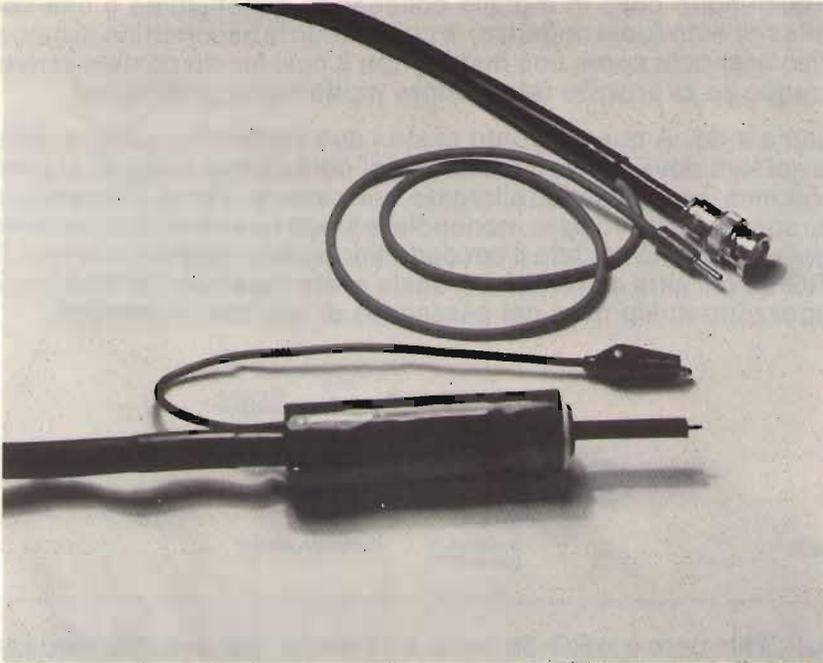
*Sonda con puntale contenente circuito adattatore di impedenza.
