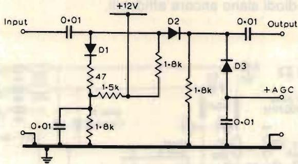
Circuito attenuatore a diodi PIN adattabile ai tipi 5082/3080/81 Hewlett Packard MPN3411/12 Motorola; BA379 Siemens pilotabile da una tensione CAG.
