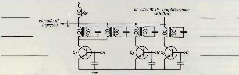
Polarizzando positivamente una qualsiasi delle tre basi contrassegnate con A, B, C si mandano in conduzione i rispettivi Q<sub>1</sub>, Q<sub>2</sub> e Q<sub>3</sub>, i quali fanno capo a tre circuiti risonanti su diverse frequenze cosicché il circuito di ingresso vedrà, a seconda dei casi, diversi accordi di sintonia; questo è un modo assai elegante per effettuare cambi cambi di gamma in ricevitori destinati a diverse bande di lavoro.
